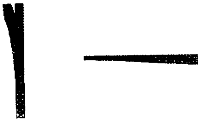
图5 8节段拱架的第1阶失稳模态
