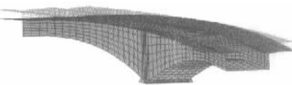
图 5 不计桥墩作用时箱梁悬臂恒载变形对照图 (图中虚线为结构设计图)
